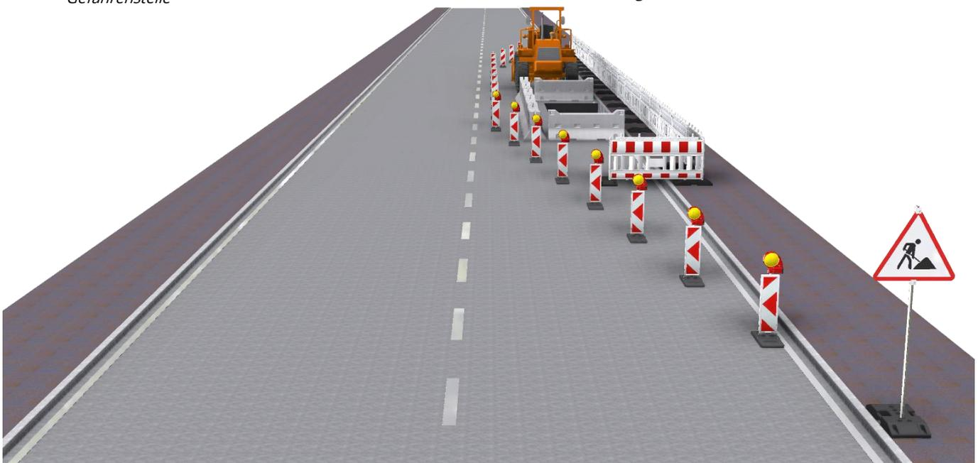
Abb. 4: Betonelemente in einer Tiefbaustelle mit Straßensperrung als Absturzsicherung und Anfahrtschutz mit Schranken, zäunen und Warnleuchten als zusätzliche Absperrelemente
