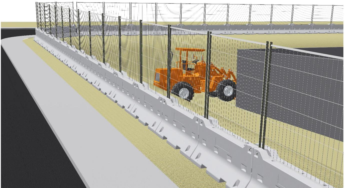
Abb. 6: Betonelemente mit individuellem Sonder-Absperrbügel speziell nach Kundenwunsch zur Absturzsicherung an einer gefährlichen Klippe an einem kombinierten Fuß- und Radweg
