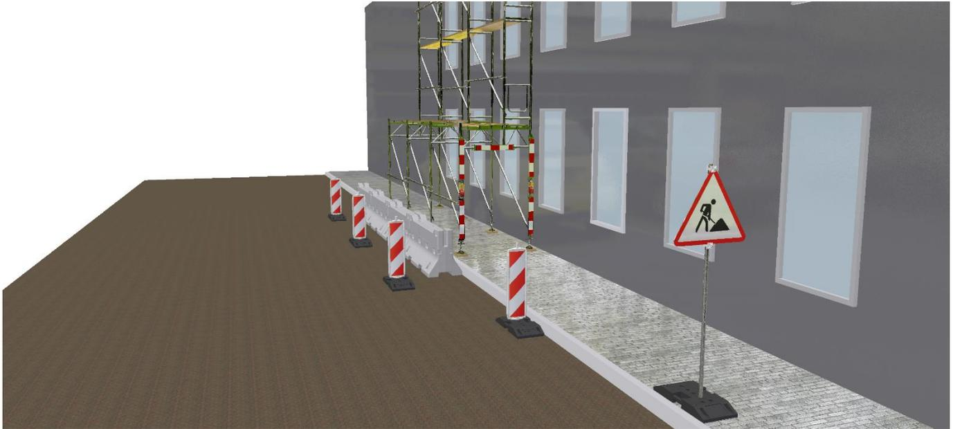
Bei der Verwendung im Straßenverkehr ist zu beachten, dass Betonelemente ein Verkehrshindernis nach §32 StVO darstellen. Sie müssen durch zusätzliche Absperr- oder leitelemente sowie bei schlechten Lichtverhältnissen durch den Einsatz von Warnleuchten gekennzeichnet werden, wie in Abb. 2 bis 4 zu sehen.
